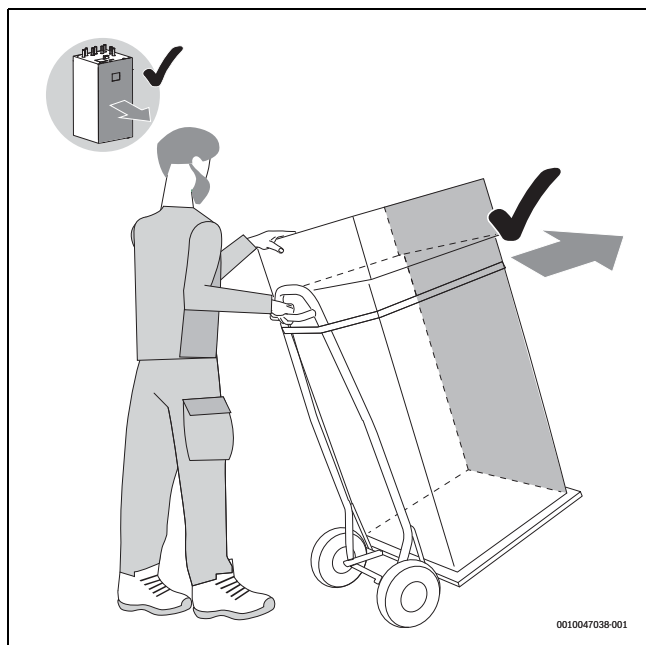
Rys. 9 Transport jednostki wewnętrznej wózkiem transportowym
